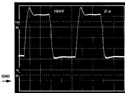
図34 .  $V_S = +5\text{ V}, 0\text{ V}$ 、ゲイン2のインバータ応答
