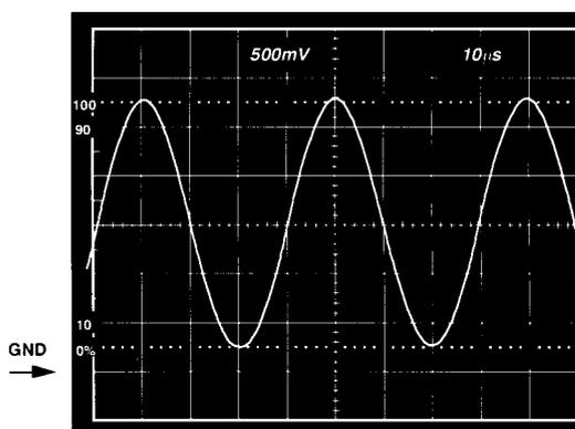
図35 .  $V_S = 3\text{ V}, 0\text{ V}$ 、ゲイン2のインバータ応答、 $V_{IN} = 1.25\text{ V}$ 、
