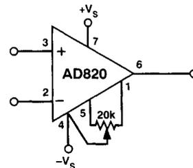
図41 . オフセット調整回路
