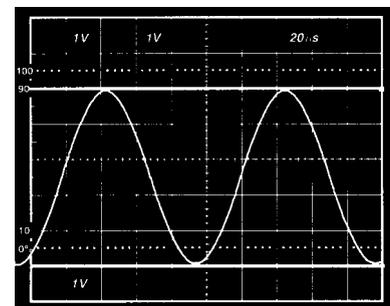
ゲイン2のアンプ； $V_S = +5$ 、0、 $V_{IN} = 2.5$ V正弦波(1.25Vセンター)
