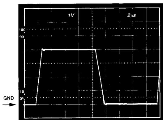
図26.  $V_S = +5\text{V}$ , 0V, ユニティ・ゲイン・フォロア応答
