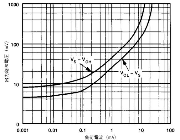
図18. 出力飽和電圧と負荷電流
