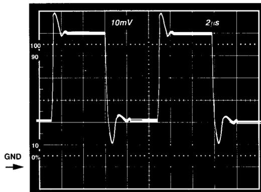
図33 .  $V_S = +5\text{ V}, 0\text{ V}$ 、ユニティ・ゲイン・フォロア応答
