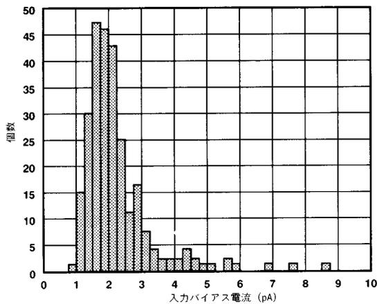
図3. 入力バイアス電流の代表分布(213個)
