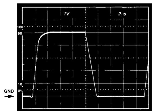
図29.  $V_S = +5\text{V}$ , 0V, ユニティ・ゲイン・フォロア応答
