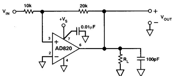
図31 . ゲイン2のインバータ回路
