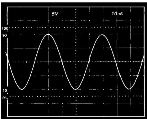
図25. 20V、25kHz正弦波入力、ユニティ・ゲイン・フォロア
