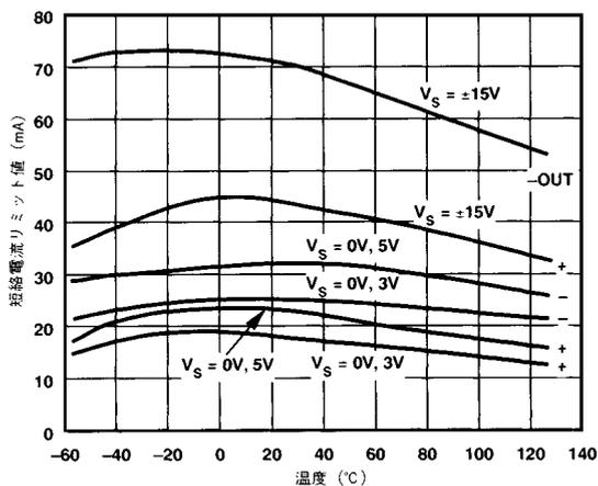
図20. 短絡電流リミット値の温度特性
