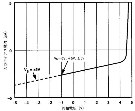
図4. 入力バイアス電流と同相電圧
