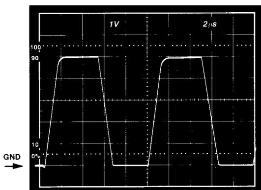
図32 .  $V_S = +5\text{ V}, 0\text{ V}$ 、ゲイン2のインバータ応答
