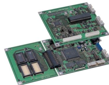
評価ボードはグラフィックスボード(AG-2)、CPUボード、メモリーボードの3つのボードから構成されます。メモリーボードには、フラッシュROMとSRAMの2種類を用意しています。メモリーボードへは開発支援ソフトからのプログラム及びCGROMデータをオンボードでダウンロード可能です。
