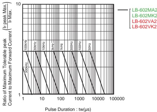
Fig.6 最大許容ピーク電流-パルス幅 ( III )
