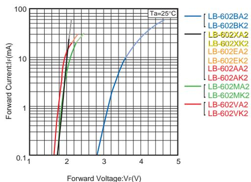
Fig.1 順方向電流－順方向電圧特性
