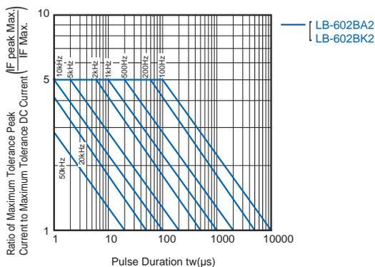
Fig.4 最大許容ピーク電流-パルス幅 ( I )
