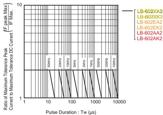
Fig.5 最大許容ピーク電流-パルス幅 ( II )
