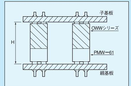
H寸法はPMW-61を使用した場合の親基板と子基板の間隔です。
