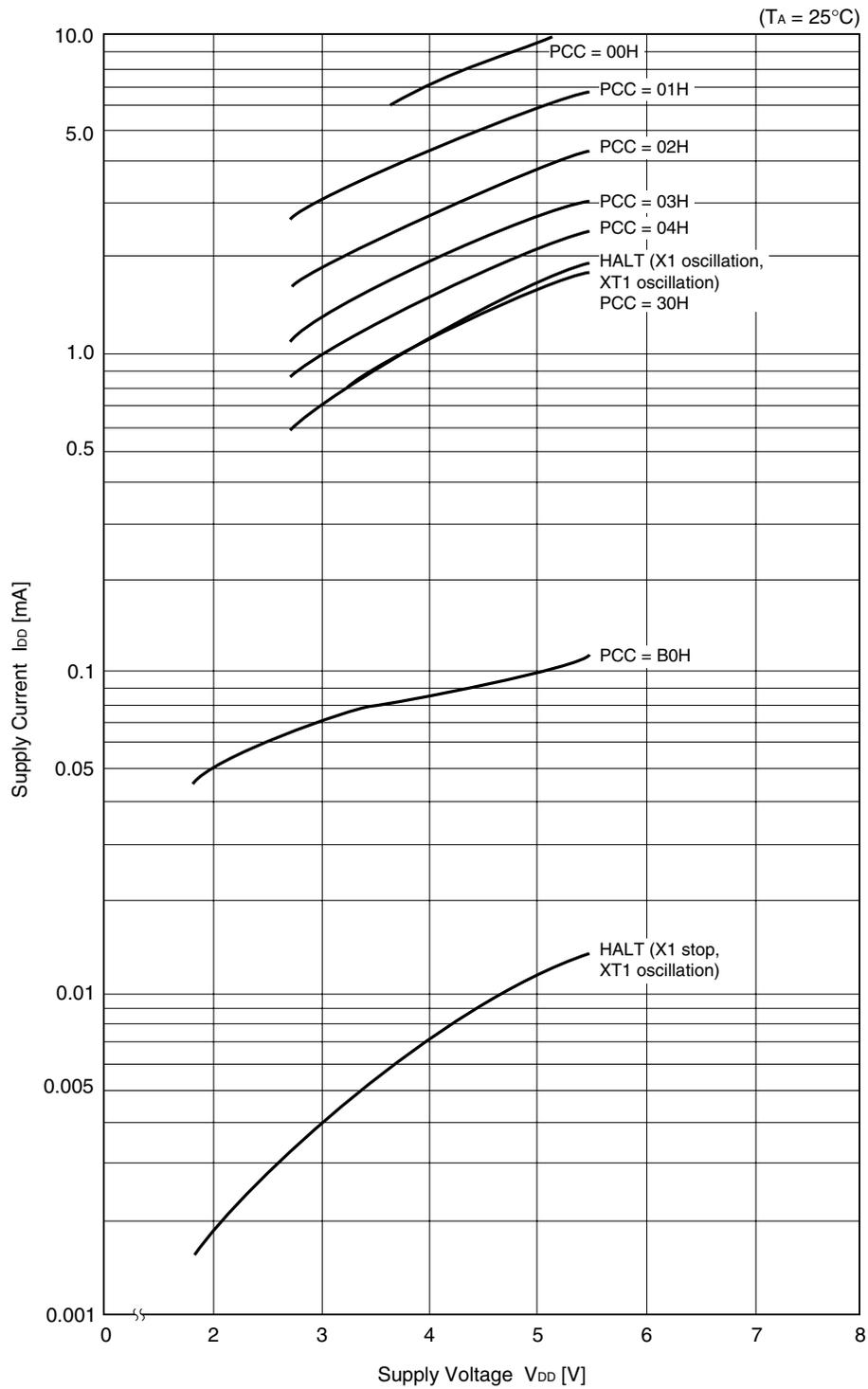
I<sub>DD</sub> VS V<sub>DD</sub> (f<sub>x</sub> = 5.0 MHz, f<sub>xx</sub> = 2.5 MHz)
